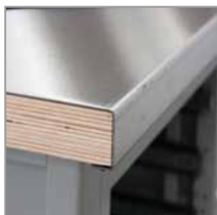
Sperrholz #36 mm oder MDF #36 mm, bedeckt mit säuref- estem Blech 1,5 mm
